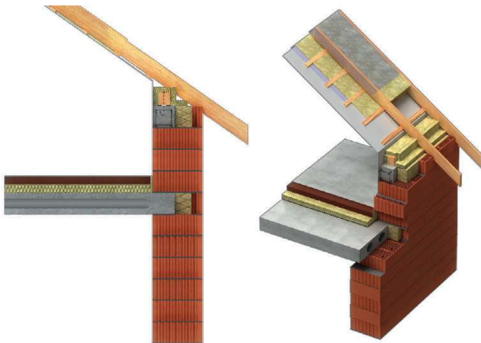
Рис. 14. Устройство скатной кровли. Крепление мауэрлата к монолитному бетонному поясу
